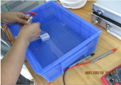
Description:Water pump test
