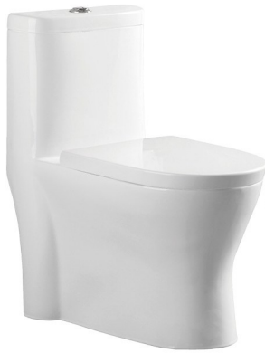
DA8070 虹吸/直冲连体坐便器 Siphonic/Washdown One-piece Toilet Size: 690x370x750mm S-trap, 250, 300, 400mm Roughing-in 地排污口中心离墙250, 300, 400mm P-trap, 180mm Roughing-in 横排污口中心离地180mm
