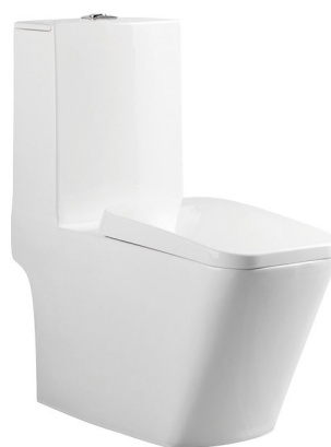
DA8030 直冲连体坐便器 Washdown One-piece Toilet Size:700x360x810mm S-trap,250mm Roughing-in 地排污口中心离墙250mm P-trap,180mm Roughing-in 横排污口中心离地180mm
