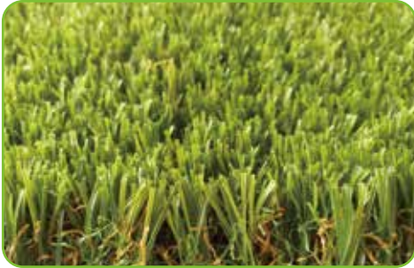
型号: FQS-3516 四色 (定制) Item: FQS-3516 4Tone (customizable) 材质: PE+PP Yarn: PE+PP 草纤维纤度: 14000 DTEX Dtex: 14000 草高: 35毫米 Pile Height: 35mm 行距: 3/8 英寸 Gauge: 3/8" 针距: 16针/10厘米 Stitches: 16/10cm 簇密度: 16800株/平方米 Density: 16800/SQM 底布: PP+网格布+丁苯合成胶 Backing: PP+net+SBR Latex
