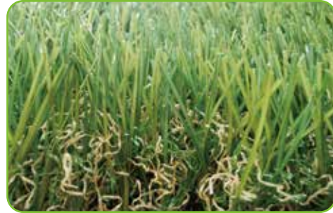
型号: CQS-40164T75 (定制) Item: CQS-40164T75 (customizable) 材质: PE+PP Yarn: PE+PP 草纤维纤度: 7500 DTEX Dtex: 7500 草高: 40毫米 Pile Height: 40mm 行距: 3/8 英寸 Gauge: 3/8" 针距: 16针/10厘米 Stitches: 16/10cm 簇密度: 16800株/平方米 Density: 16800/SQM 底布: PP+网格布+丁苯合成胶 Backing: PP+net+SBR Latex
