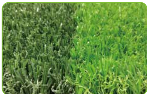
型号: MCS-3018 Item: MCS-3018 材质: PE+PP Yarn: PE+PP 草纤维纤度: 15000 DTEX Dtex: 15000 草高: 30毫米 Pile Height: 30mm 行距: 3/8 英寸 Gauge: 3/8" 针距: 18针/10厘米 Stitches: 18/10cm 簇密度: 18900株/平方米 Density: 18900/SQM 底布: PP+网格布+丁苯合成胶 Backing: PP+net+SBR Latex
