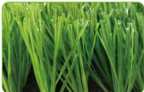
型号: CDS-5001 Item: CDS-5001 材质: PE Yarn: PE 草纤维纤度: 7500 DTEX Dtex: 7500 草高: 50毫米 Pile Height: 50mm 行距: 3/4 英寸 Gauge: 3/4" 针距: 20针/10厘米 Stitches: 20/10cm 簇密度: 10500株/平方米 Density: 10500/SQM 底布: PP+网格布+丁苯合成胶 Backing: PP+net+SBR Latex
