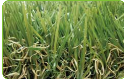
型号: QS-3516 四色 Item: QS-3516 4Tone 材质: PE+PP Yarn: PE+PP 草纤维纤度: 11000 DTEX Dtex: 11000 草高: 35毫米 Pile Height: 35mm 行距: 3/8 英寸 Gauge: 3/8" 针距: 16针/10厘米 Stitches: 16/10cm 簇密度: 16800株/平方米 Density: 16800/SQM 底布: PP+网格布+丁苯合成胶 Backing: PP+net+SBR Latex
