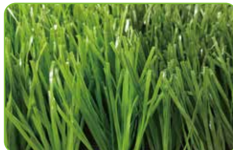
型号: DS-5002 Item: DS-5002 材质: PE Yarn: PE 草纤维纤度: 8800 DTEX Dtex: 8800 草高: 50毫米 Pile Height: 50mm 行距: 3/4 英寸 Gauge: 3/4" 针距: 20针/10厘米 Stitches: 20/10cm 簇密度: 10500株/平方米 Density: 10500/SQM 底布: PP+网格布+丁苯合成胶 Backing: PP+net+SBR Latex
