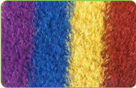
型号: 25彩色跑道 Item: 25 Rainbow runway 材质: PE+PP Yarn: PE+PP 草纤维纤度: 9000 DTEX Dtex: 9000 草高: 25毫米 Pile Height: 25mm 行距: 3/8 英寸 Gauge: 3/8" 针距: 16针/10厘米 Stitches: 16/10cm 簇密度: 16800株/平方米 Density: 16800/SQM 底布: PP+网格布+丁苯合成胶 Backing: PP+net+SBR Latex
