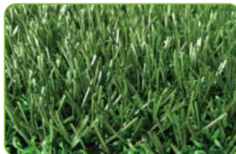
型号: YK-3018 Item: YK-3018 材质: PE Yarn: PE 草纤维纤度: 16000 DTEX Dtex: 16000 草高: 30毫米 Pile Height: 30mm 行距: 3/8 英寸 Gauge: 3/8" 针距: 18针/10厘米 Stitches: 18/10cm 簇密度: 18900株/平方米 Density: 18900/SQM 底布: PP+网格布+丁苯合成胶 Backing: PP+net+SBR Latex
