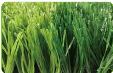
型号: DS-50J09 Item: DS-50J09 材质: PE Yarn: PE 草纤维纤度: 10000 DTEX Dtex: 10000 草高: 50毫米 Pile Height: 50mm 行距: 3/4 英寸 Gauge: 3/4" 针距: 20针/10厘米 Stitches: 20/10cm 簇密度: 10500株/平方米 Density: 10500/SQM 底布: PP+网格布+丁苯合成胶 Backing: PP+net+SBR Latex
