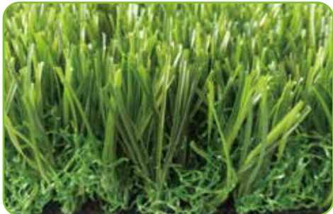
型号: UQS-3516 三色 (定制) Item: UQS-3516 3Tone (customizable) 材质: PE+PP Yarn: PE+PP 草纤维纤度: 13000 DTEX Dtex: 13000 行距: 3/8 英寸 Gauge: 3/8" 草高: 35毫米 Pile Height: 35mm 针距: 16针/10厘米 Stitches: 16/10cm 簇密度: 16800株/平方米 Density: 16800/SQM 底布: PP+网格布+丁苯合成胶 Backing: PP+net+SBR Latex
