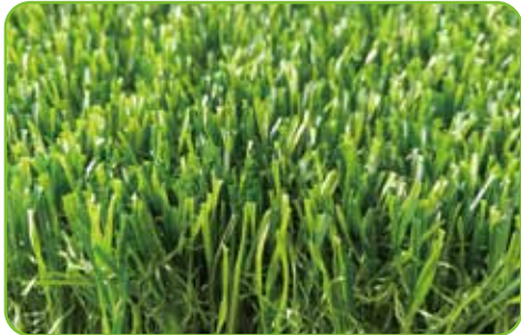
型号: W6081-3520 Item: W6081-3520 材质: PE+PP Yarn: PE+PP 草纤维纤度: 9000 DTEX Dtex: 9000 草高: 35毫米 Pile Height: 35mm 行距: 3/8 英寸 Gauge: 3/8" 针距: 20针/10厘米 Stitches: 20/10cm 簇密度: 21000株/平方米 Density: 21000/SQM 底布: PP+网格布+丁苯合成胶 Backing: PP+net+SBR Latex
