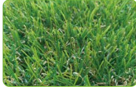
型号: XQS-2518四色 (定制) Item: XQS-2518 4Tone 材质: PE+PP Yarn: PE+PP 草纤维纤度: 8500 DTEX Dtex: 8500 草高: 25毫米 Pile Height: 25mm 行距: 3/8 英寸 Gauge: 3/8" 针距: 18针/10厘米 Stitches: 18/10cm 簇密度: 18900株/平方米 Density: 18900/SQM 底布: PP+网格布+丁苯合成胶 Backing: PP+net+SBR Latex
