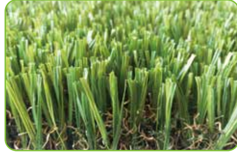
型号: SQS-3516 四色 (定制) Item: SQS-3516 4Tone (customizable) 材质: PE+PP Yarn: PE+PP 草纤维纤度: 13500 DTEX Dtex: 13500 草高: 35毫米 Pile Height: 35mm 行距: 3/8 英寸 Gauge: 3/8" 针距: 16针/10厘米 Stitches: 16/10cm 簇密度: 16800株/平方米 Density: 16800/SQM 底布: PP+网格布+丁苯合成胶 Backing: PP+net+SBR Latex
