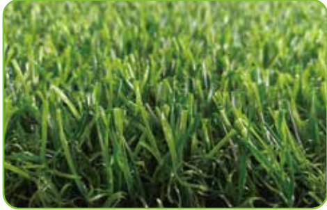
型号: W6081-2516 Item: W6081-2516 材质: PE+PP Yarn: PE+PP 草纤维纤度: 9000 DTEX Dtex: 9000 草高: 25毫米 Pile Height: 25mm 行距: 3/8 英寸 Gauge: 3/8" 针距: 16针/10厘米 Stitches: 16/10cm 簇密度: 16800株/平方米 Density: 16800/SQM 底布: PP+网格布+丁苯合成胶 Backing: PP+net+SBR Latex
