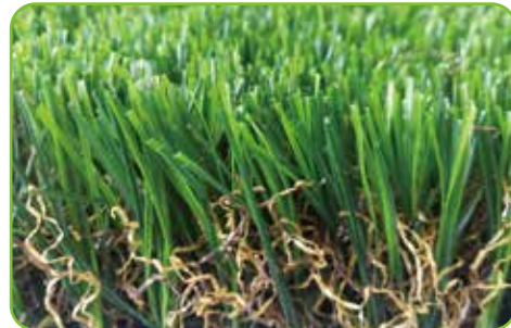
型号: UQS-3516 四色 (定制) Item: UQS-3516 4Tone (customizable) 材质: PE+PP Yarn: PE+PP 草纤维纤度: 13000 DTEX Dtex: 13000 草高: 35毫米 Pile Height: 35mm 行距: 3/8 英寸 Gauge: 3/8" 针距: 16针/10厘米 Stitches: 16/10cm 簇密度: 16800株/平方米 Density: 16800/SQM 底布: PP+网格布+丁苯合成胶 Backing: PP+net+SBR Latex
