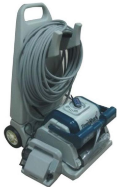
名称:虎鲨全自动泳池清洗机 型号:TigerShark2 Plus 功率:300W 工作电压:220V 水下电压:24V 清洗速度:12m/分 线长:30m 体积:500*460*380mm
