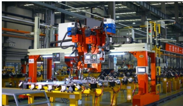
自动焊接机器人 120m×3.4m Automatic welding robot
