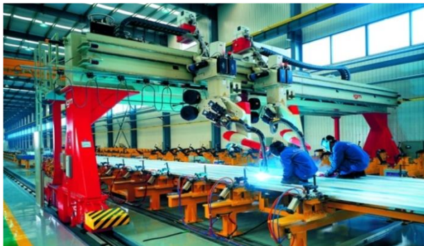
自动焊接机器人 120m×11m Automatic welding robot
